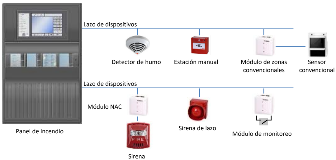
Ilustración 12. Esquema General Sistema de Detección de Incendio
